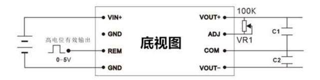
备注: 1、1电位器为反馈电阻输入端,必须接或者短接,不需要调节可以要求去掉这个功能。
