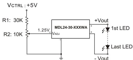
$$V_{ADJ} = \frac{R2}{R1 + R2} \times V_{CTRL}$$
